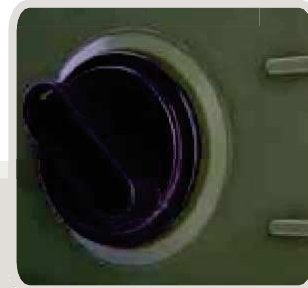
Tapón de desagüe
